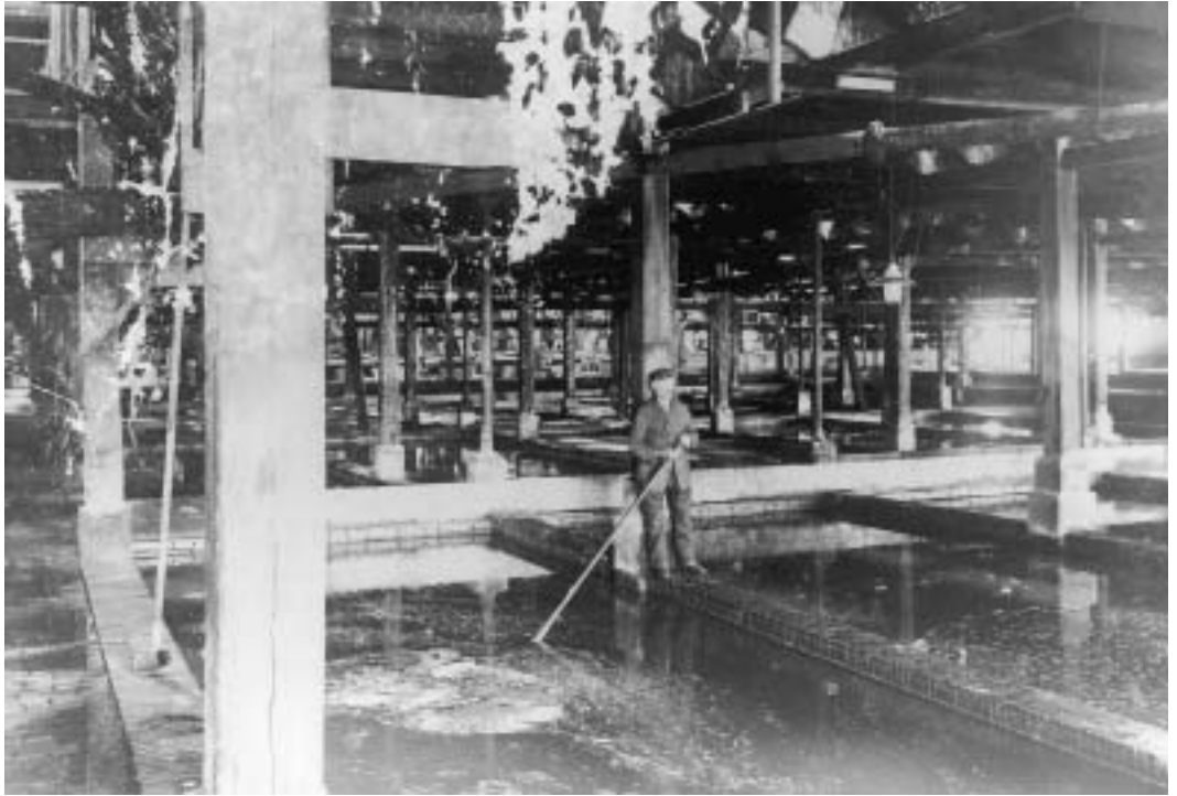
Meelbassins in de aardappelmeelfabriek in Foxhol. Hier werd het meel gewassen en daarna gezeefd (begin 20 e eeuw)
